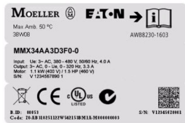
Abb. 11: Typenschild des Frequenzumrichters MMX34AA3D3F0-0
